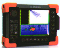
CTS-2108PA 便携式相控阵超声检测仪
