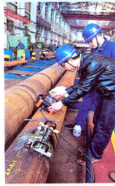
压力钢管检测
