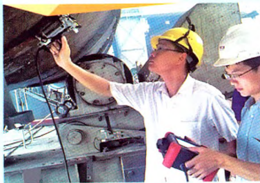
压力容器焊缝检测
