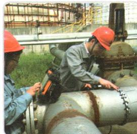
管道环焊缝检测
