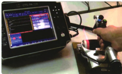
复合材料C扫检测
