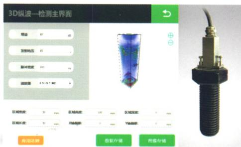
螺栓的3D全聚焦检测
