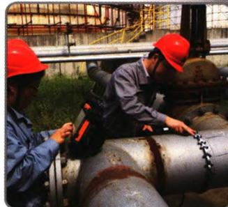
中径管环形焊缝
