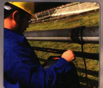
小径管环形焊缝
