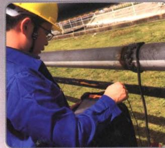
小径管环形焊缝
