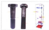
铁路螺栓实时3D全聚焦成像检测
