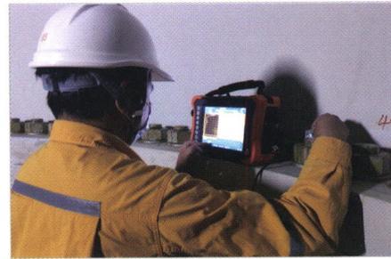
风电螺栓等各类紧固螺栓检测
