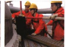
不锈钢容器焊缝检测
