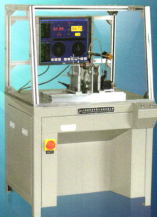
自动定位平衡机 Auto-positioning balancing machine
