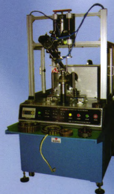
外转子定子全自动绕线机 (有单工位和双工位)
