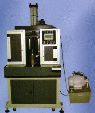
定子氩弧焊机 (分内孔张紧式和非内孔张紧式)
