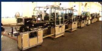
S1机械步进式 转子生产线
