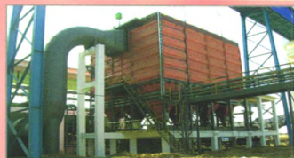
KBDW干法卧式静电除尘器 (专利号: ZL200720046188. 9)
