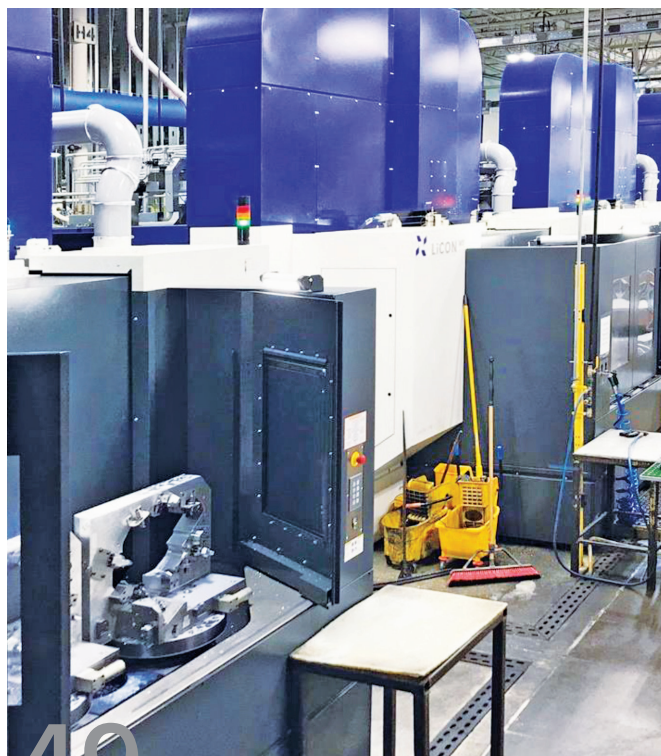
LICON MT 的五台柔性双主轴加工中心对 Trace 压铸有限公司的生产至关重要，它们用于生产电机外壳
