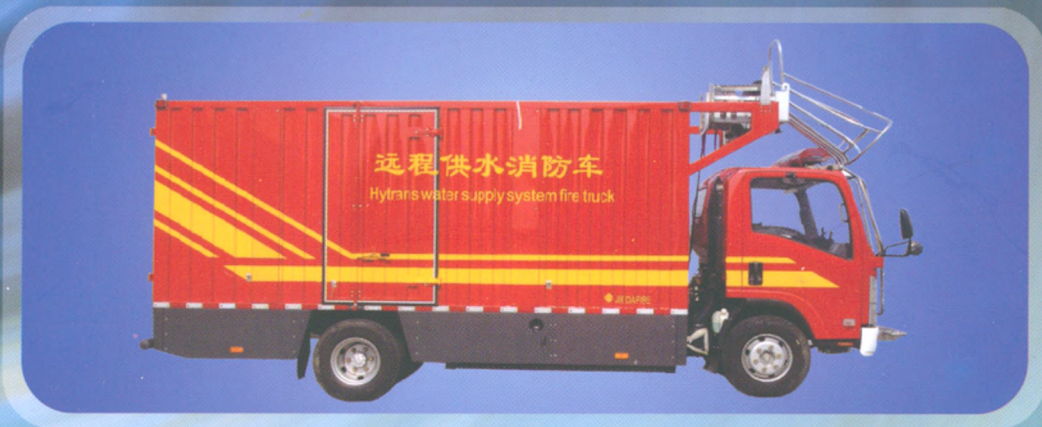
水带敷设消防车
