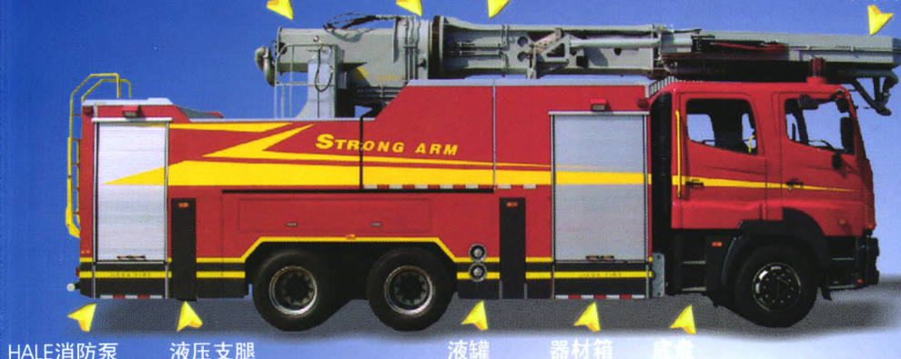
HALE消防泵 液压支腿 液罐 器材箱 底盘
