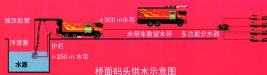
桥面码头供水示意图
