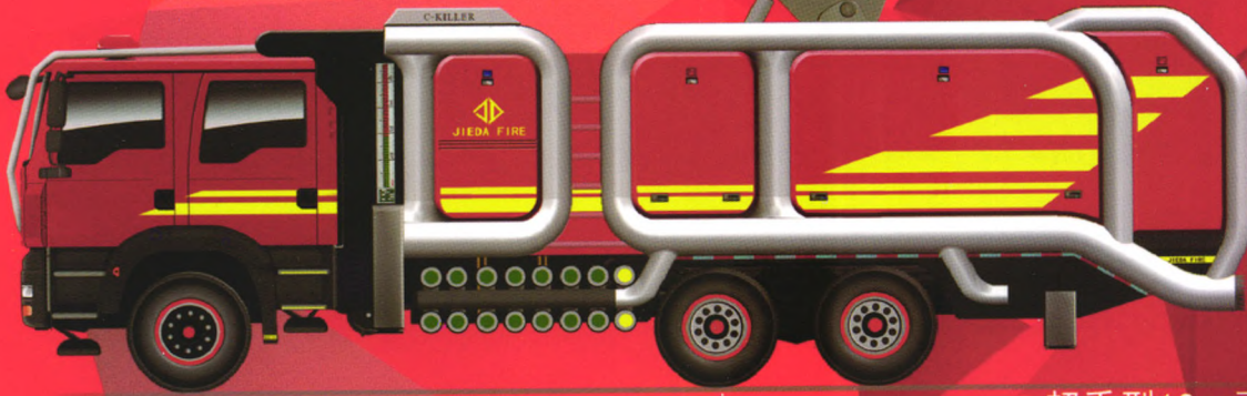
超重型10 m高喷泡沫消防车
