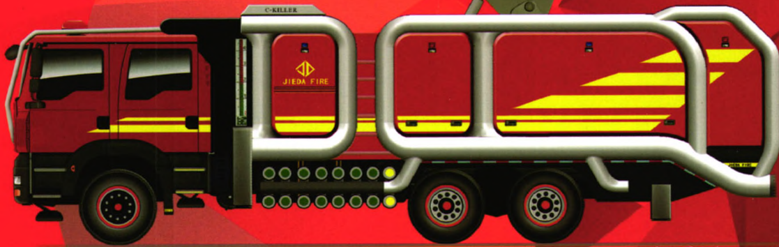
超重型10 m高喷泡沫消防车
