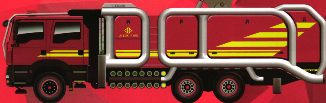
● 超重型10 m高喷泡沫消防车
