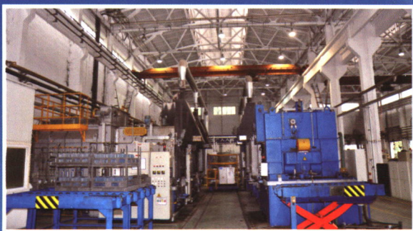
多用炉渗碳淬火生产线
