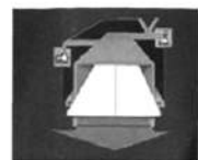
空气输送斜槽
