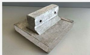
**1:4原则: 1mm 纳米隔热材料相当于4mm传统保温材料**
