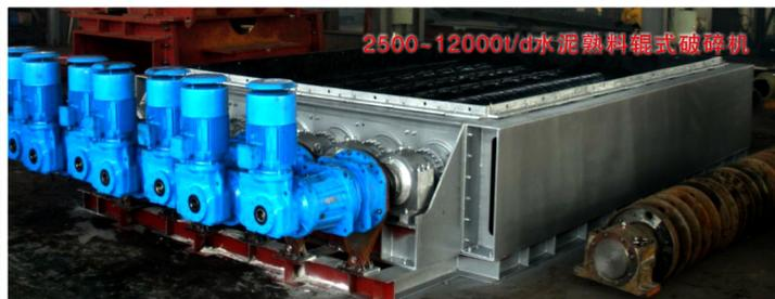
2500-12000t/d水泥熟料辊式破碎机
