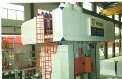
标致-雪铁龙项目: HE600-1500配1500吨液压机LFT-D生产线 及HET1000配四角调平液压机
