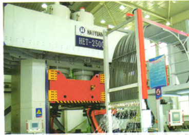
宇通客车项目: HE600-2500-4000配2500吨 和4000吨液压机LFT-D生产线
