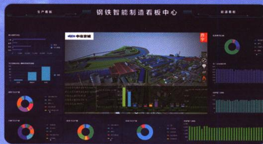
基于BIM技术、GIS技术、VR/AR技术，贯穿于工厂设计、施工、运维的工程全生命周期管理，充分应用于生产管理、物流管理、能源管理、设备管理、安防管理和应急管控，构建虚拟与现实的数字化孪生工厂。
