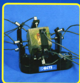
DSA差应变测试装置 测量立方体试样三向地应力
