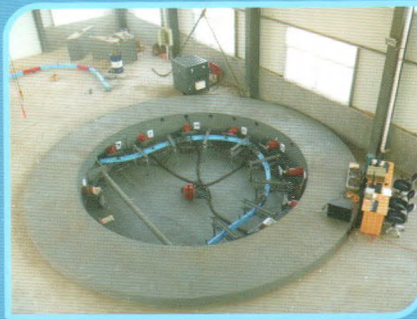
深部巷道拱架大型力学试验系统
