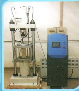
大直径可预置流固耦合试验装置
