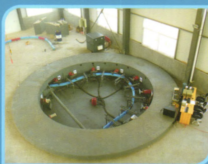
深部巷道拱架大型力学试验系统
