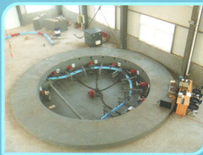
深部巷道拱架大型力学试验系统
