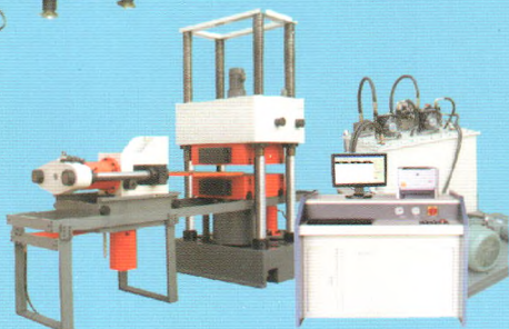
▶ 室内大型抗压性能试验平台
