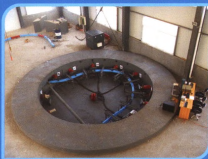
深部巷道拱架大型力学试验系统
