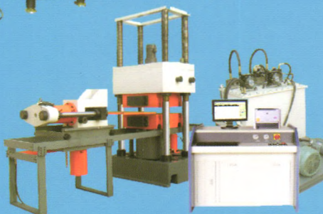
▶ 室内大型抗压性能试验平台
