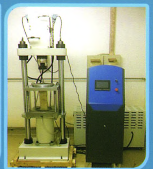
大直径可预置流固耦合试验装置
