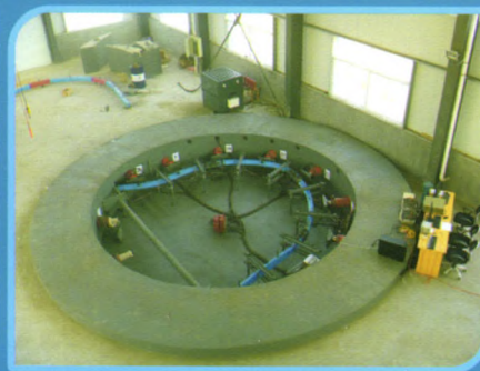
深部巷道拱架大型力学试验系统
