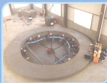
深部巷道拱架大型力学试验系统
