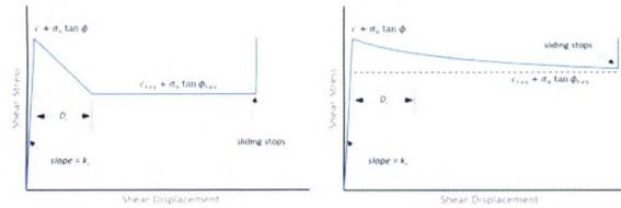
2. 蠕变接触模型：指在已有成熟接触模型基础上进一步考虑现实结构面可以具有的蠕变性质，如含软弱介质充填的断层。
