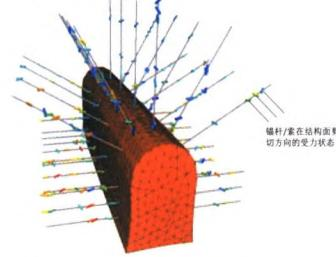
新版程序提供一种全新的支护类型即混合锚杆/索单元以实现对结构面法向、剪切向作用效应的综合描述，合理体现了锚杆/索对结构面揭露部位的“销钉”作用。
