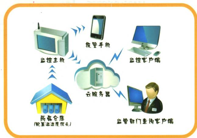
天大天发——专业药检仪器厂家，最新推出 WSK-1 无线温湿度云监控系统，完全符合 GSP 《药品经营质量管理规范》的要求，适用于储存药品仓库对药品储存过程的温湿度状况进行实时自动监测和记录，能有效防范储存运输过程中可能发生的影响药品质量安全、风险，确保药品质量安全。监管部门可在线监控。
