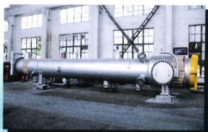
严酷条件下工业转化气大型废热锅炉
