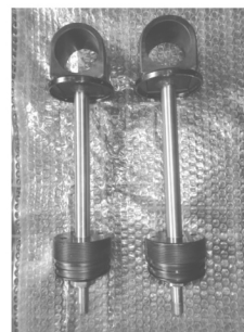
图9 活塞杆焊后实物
