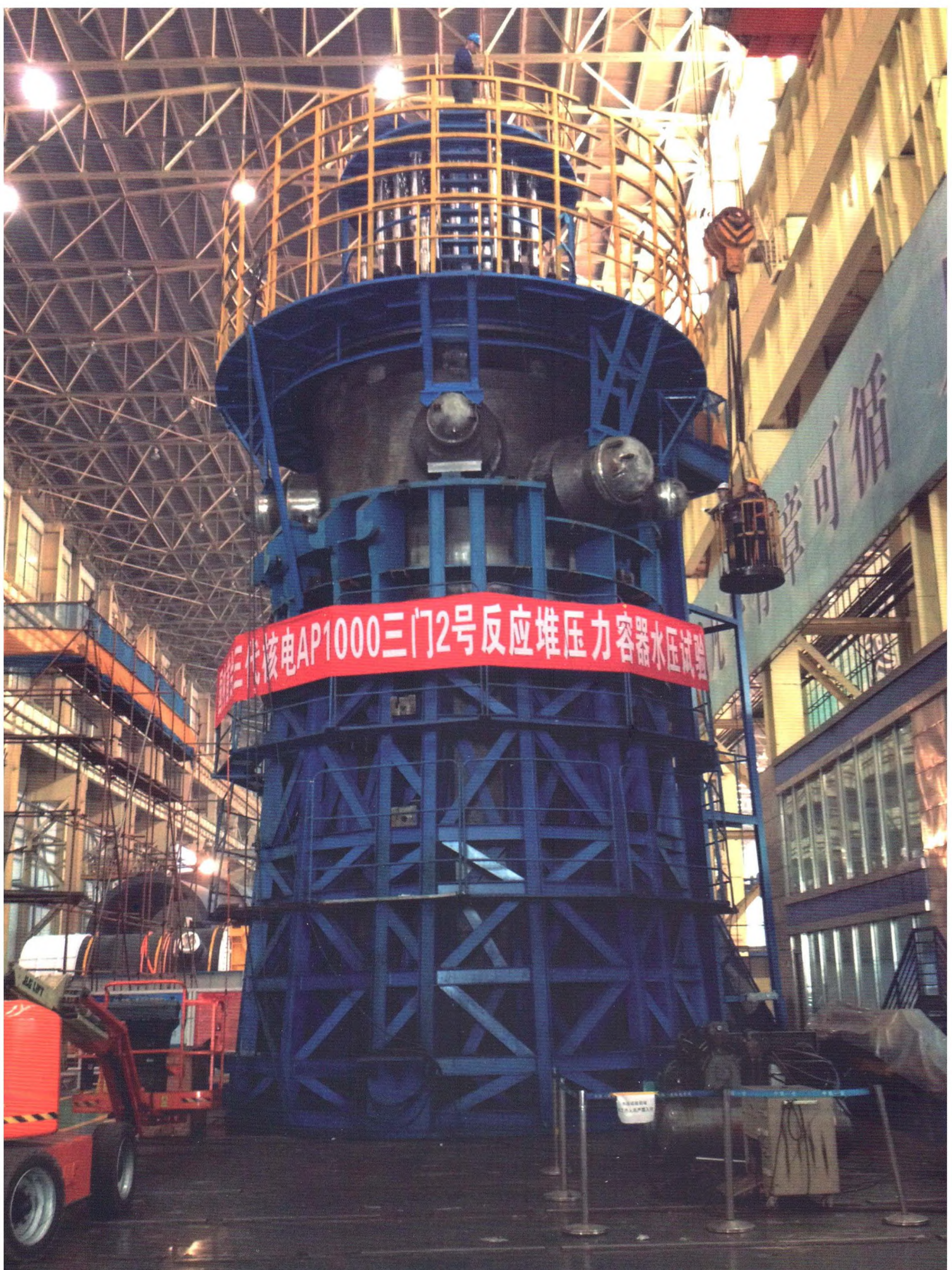
首台国产化AP1000反应堆压力容器——三门核电2号机组水压
