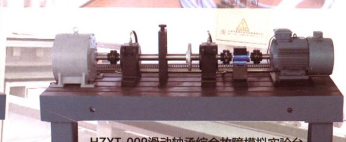
HZXT-009滑动轴承综合故障模拟实验台
