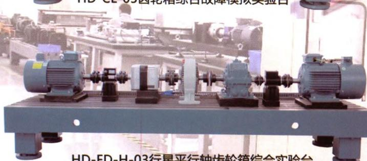
HD-FD-H-03行星平行轴齿轮箱综合实验台
