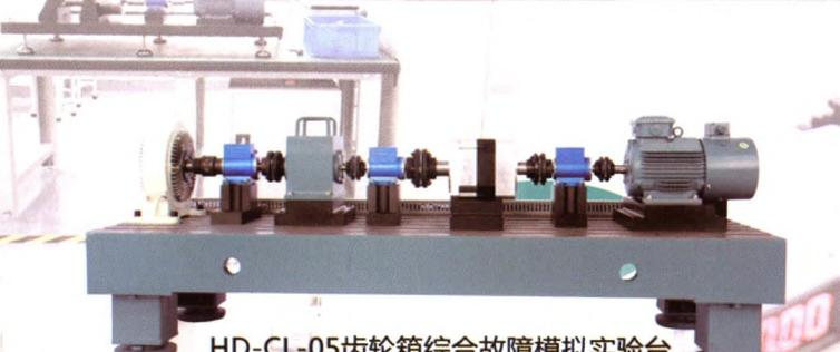
HD-CL-05齿轮箱综合故障模拟实验台
