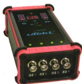
每个采集器 4 通道，采集器采用 WIFI 无线网络连接，支持 Android 终端、桌面计算机终端、手机终端。内置智能传感器（TEDS 传感器）识别功能。
