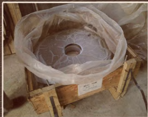
我公司待发往鄂钢的5000t轧制力传感器
