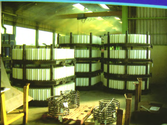
◎装配中的反冲洗过滤机
