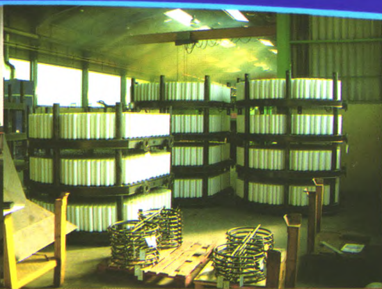
◎装配中的反冲洗过滤机
