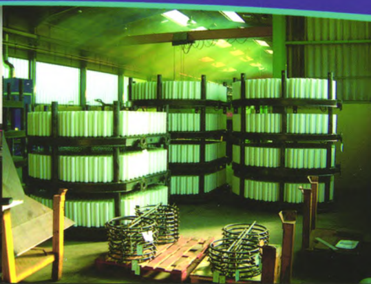
◎装配中的反冲洗过滤机
