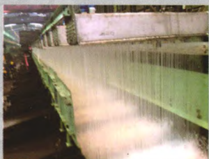
与武钢—钢轧合作对 1700 轧机均匀快冷技改已成功投入运行
