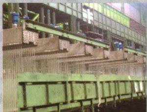
与武钢—钢轧合作对 1700 轧机均匀快冷技改已成功投入运行
