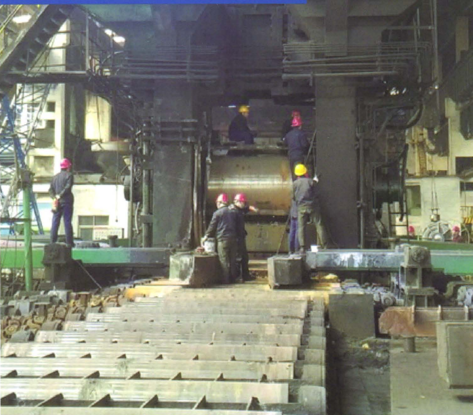
现场待安装的莆田力天35MN轧制力传感器
