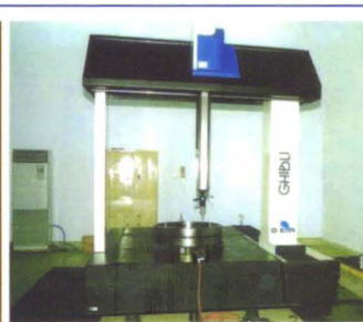
意大利GHI BLI201514型CNC三座标测量机
