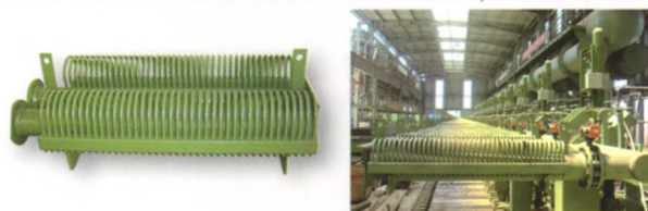
层流均匀快冷、超快冷系统 与武钢一钢轧合作对 1700 轧机均匀快冷技改已成功投入运行
