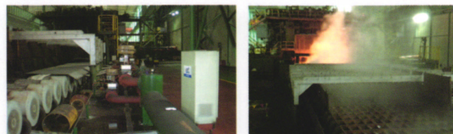
层流均匀快冷、超快冷系统 与武钢一钢轧合作对 1700 轧机均匀快冷技改已成功投入运行
