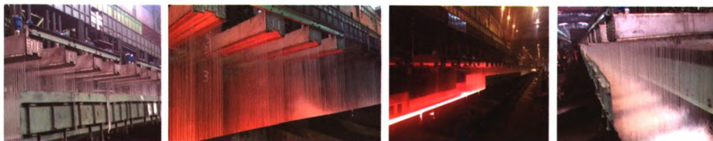
层流均匀快冷、超快冷系统 与武钢一钢轧合作对 1700 轧机均匀快冷技改已成功投入运行
